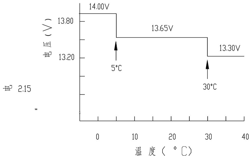
2V 系列铅晶电池：（温度在 25℃时，电池的浮充电压为：2.23±0.1V/台）
